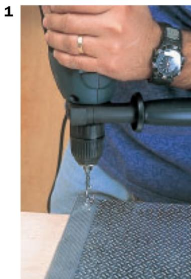
1. Percer l'intérieur du rivet avec un foret à métaux au bon diamètre.
